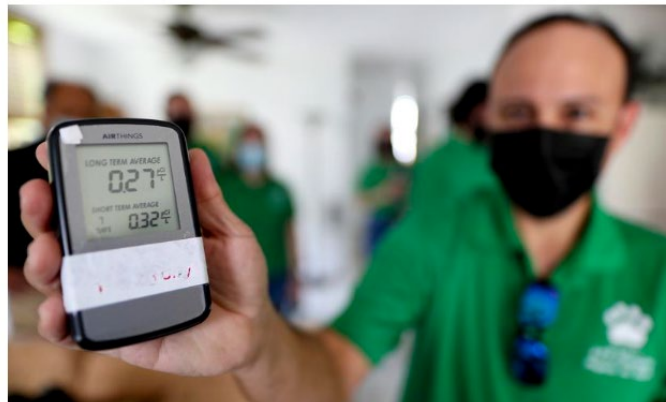
Los monitores electrónicos de radón se instalan en los hogares por una semana. En la foto, el profesor Pedro Tarafa Vélez. (David Villafañe Ramos)
